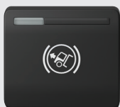
MAN EASYSTART ระบบช่วยออกตัวทางลาดชัน
